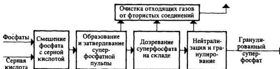
Рисунок 3.1 – Функциональная схема производства простого суперфосфата
